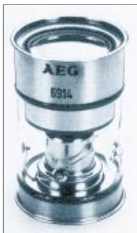
Bild 4: Der Infrarot- bildwandler der AEG ist eine Diode mit elektro- statischer Fokussierung.
