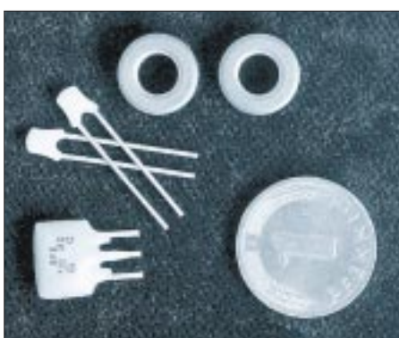
Bild 18: Komponenten für einen Keramikfilter-Bandpaß: SFE 7,02 MC2, Ringkerne FT37-77 und keramische Kondensatoren
