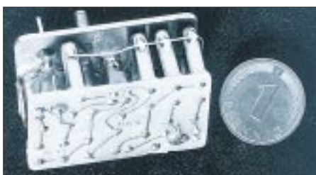
Bild 9: Offenes KVG-Filter (achtpoliges Antennen-Quarzfilter)
