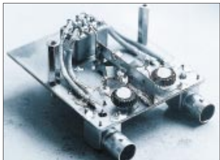
Bild 13: Keramik-Vorfilter-Versuchsaufbau von HB9JNH/AFR Fotos: DJ2EV
