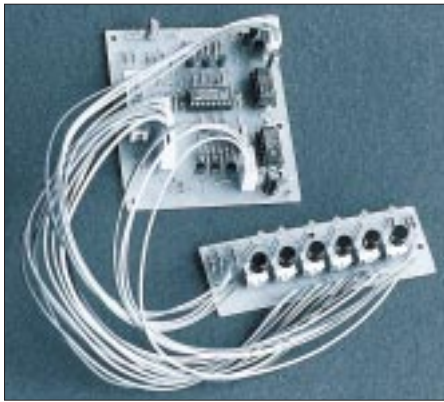
Bild 8: Ansicht des Musteraufbaus der Tiptasten-Elektronik gemäß Bild 7
